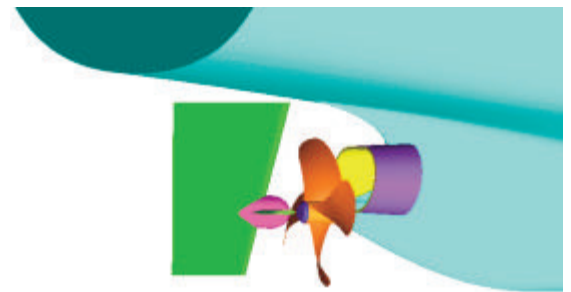
图 2 船-桨前导流管-桨-舵-舵球式推力鳍尾部模型
