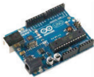
图 9 Arduino UNO 开发板
