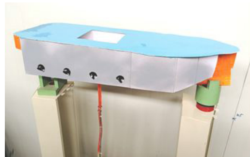
图11 M型采矿船试验模型
