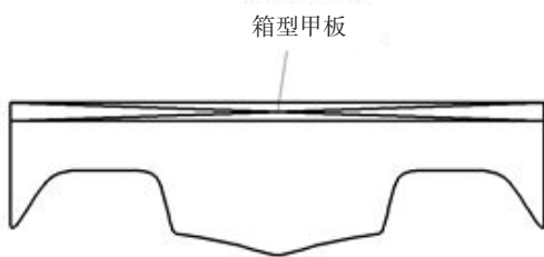
图5 M型船型横剖面示意图
